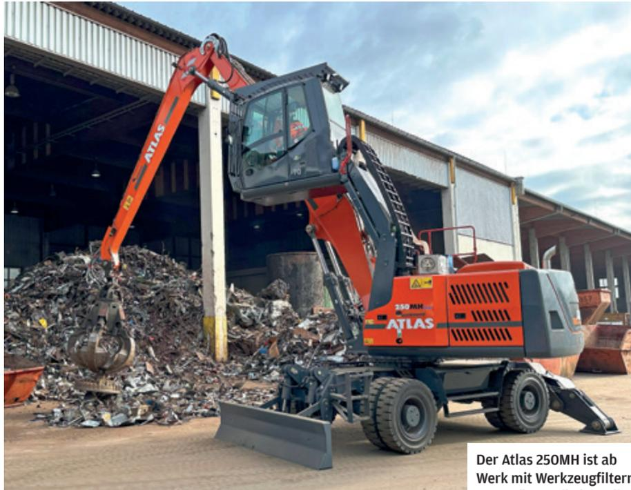
Der Atlas 250MH ist ab Werk mit Werkzeugfiltern ausgerüstet, die im Falle eines technischen Gebrechens verhindern, dass Metallspäne in das Hydrauliksystem gelangen.
